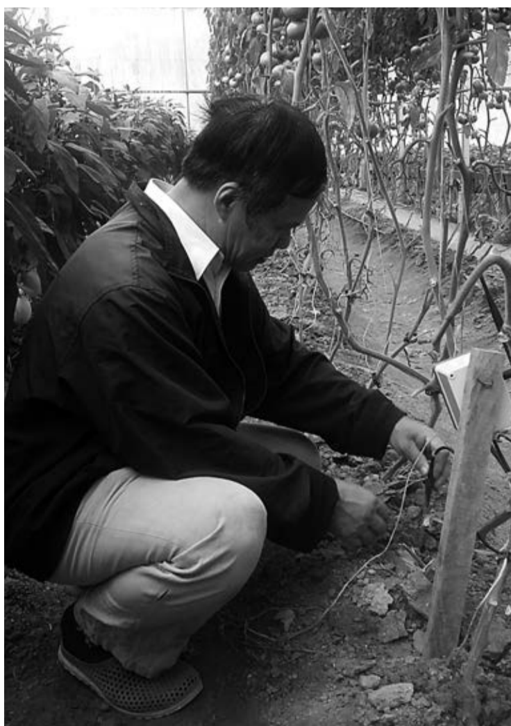
Ông Vương Đình Phi kiểm tra cảm biến đo độ ẩm đất. Ảnh: D. Quỳnh
