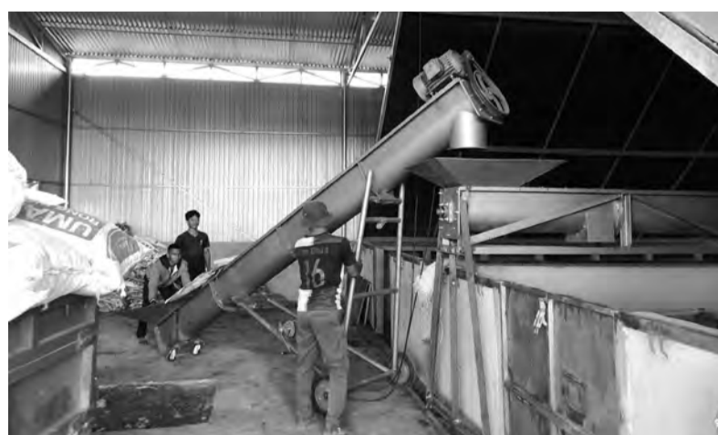
Băng chuyền đưa cà phê vào lò tại HTX Lộc Tiến.
